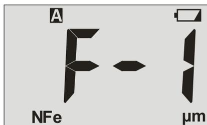
Сделайте замер на той же металлической основе вместе с эталонным покрытием известной толщины. Например 700 или 1000 µm. При необходимости повторите замер. В то время, пока отображается результат измерения коротко нажимая
