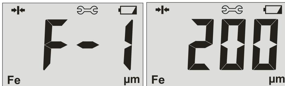
Сделайте замер металлической основы поместив на нее калибровочную пластину. При необходимости повторите измерение.
